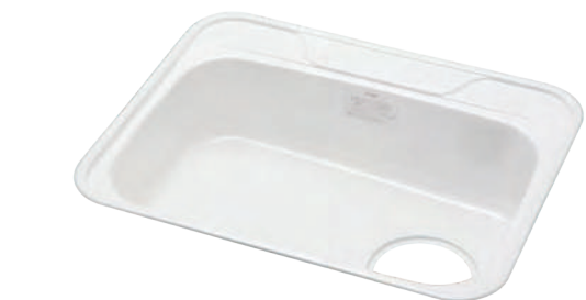
COMO-G6(R) アンダータイプ COMO-G6-○(R) オーバータイプ ボール深さ:203 水栓孔径:36φ 排水孔径:160φ 生地:18-8ステンレス 裏面:防震材 (イシバシテクノ製) 排水トラップ:φ180用
