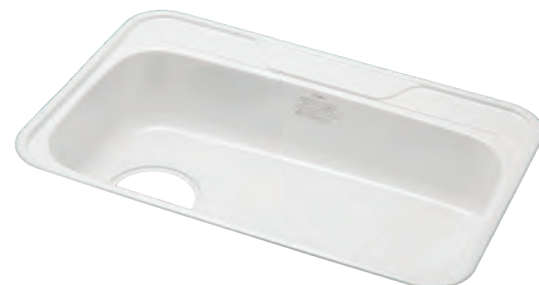
COMO-G8(L) アンダータイプ COMO-G8-○(L) オーバータイプ ボール深さ:203 水栓孔径:36φ 排水孔径:160φ 生地:18-8ステンレス 裏面:防震材 (イシバシテクノ製) 排水トラップ:φ180用
