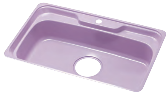
COMO-V8 アンダータイプ COMO-V8-○ オーバータイプ ボール深さ:205 水栓孔径:36φ 排水孔径:159φ 生地:18-8ステンレス 裏面:防震材 (イシバシテクノ製) 排水トラップ:φ180用
