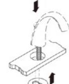
2 吐水口をナットで締めて取り付けます。リフトロッドを差し込みます。
