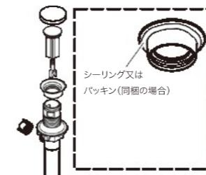
2 排水金具を取り付け、下のゴムパッキンがシンクに密着するまでナットを締めます。
