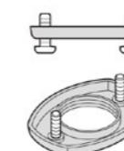
5 ハンドルの取付ネジ部にメタルワッシャー、取付用ナットの順に挿入し、取付部裏面より5mm程度のところまで取付用ナットを締め込み仮止めします。
