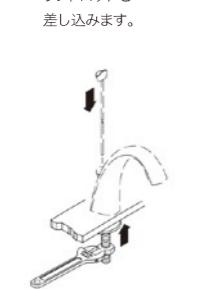
3 ハンドル底部にシーリングを施して、取付面に挿入します。
