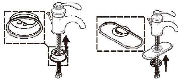
2 スタッドにクランプとワッシャーを差し込み、ナットを締めて取り付けます。
