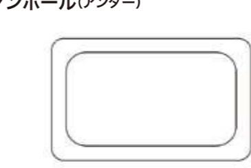
シンクに穴がないため、天板に水栓用の穴をあけて直接取り付けます。アンダータイプのシンクに多い形状です。
