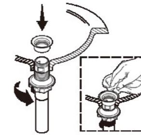
3 ロッドを排水金具に差し込み、取付ナットを締めて取り付け、ストッパーを差し込みます。
