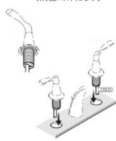
4 ハンドル底部にボルトを取り付けます。
