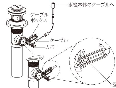
ドレン本体のカバーを開き、ケーブルの端をケーブルボックスに挿入します。図1に示すように、ケーブルボックスの両端(A、B)にカチッとはめ込みます。次に、カバーを固定します。取り付け後、リフティングヘッドを引いて、正常に動作することを確認してください。
